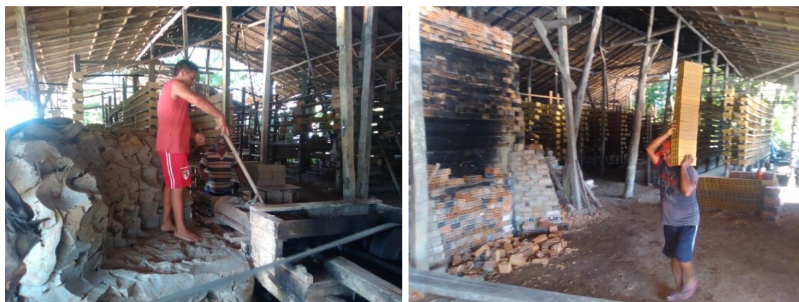
Figura 33 – Homens trabalhando na produção de tijolos, que na verdade, incia-se desde a ida à densa floresta para extração do barro. Num primeiro momento, temos o barro sendo pressionado para que possa ganhar a forma de tijolo, onde utiliza-se a força braçal. Num segundo momento, tem-se o tijolo já “seco” sendo levado para o forno. Fonte: Trabalho de campo, 2017.
